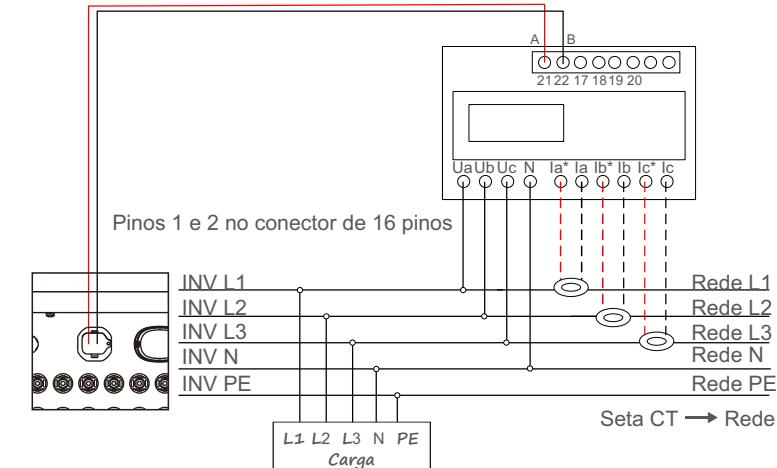
Figura 6.11 Medidor Tipo TC Externo - "Medidor na Rede"
