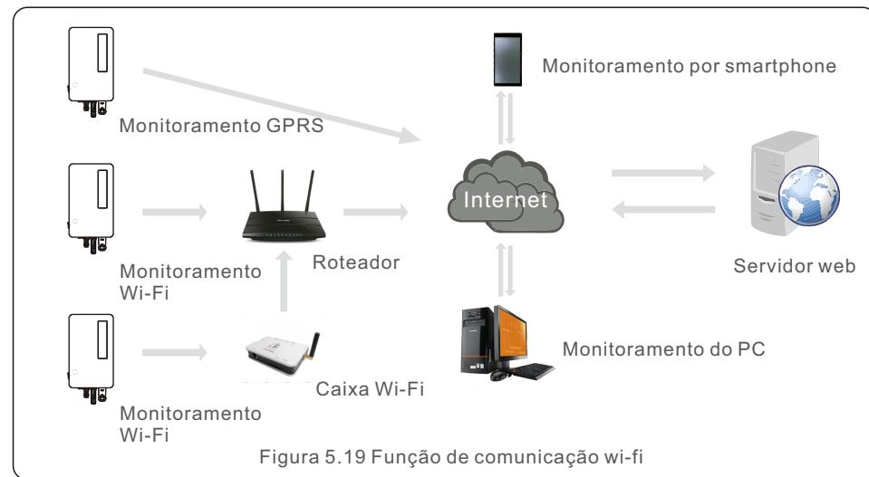
Figura 5.19 Função de comunicação wi-fi
