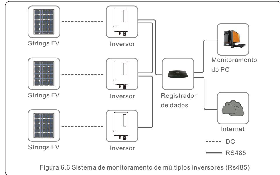
Figura 6.6 Sistema de monitoramento de múltiplos inversores (Rs485)
