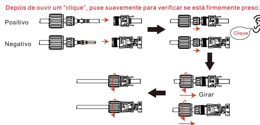
Figura 5.14 Montagem da tampa do conector do terminal
