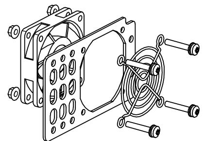
7. Desconecte o conector do ventilador com cuidado e retire o ventilador.
