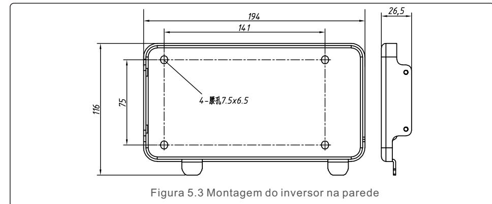
Figura 5.3 Montagem do inversor na parede
