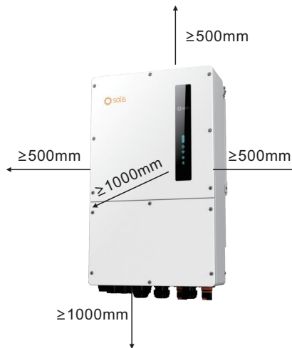
Kuva 3.5 Invertterin asennusetäisyys
