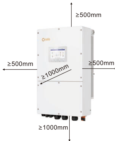
Figura 3.5 Distâncias para montagem do inversor
