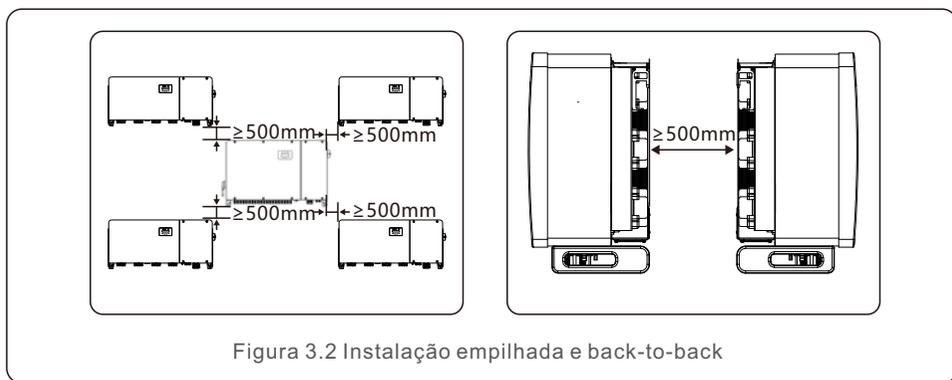
Figura 3.2 Instalação empilhada e back-to-back
