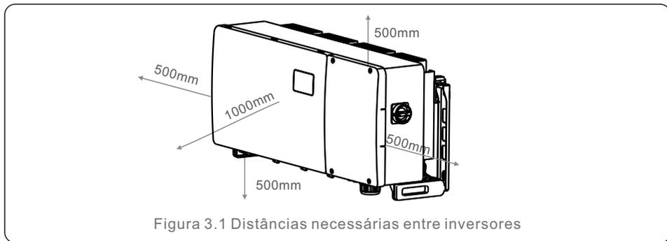
Figura 3.1 Distâncias necessárias entre inversores
