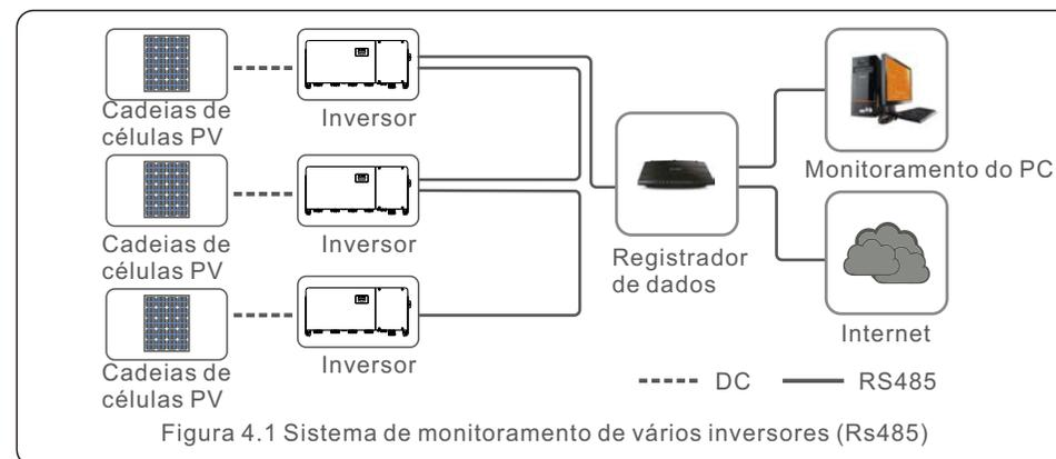
Figura 4.1 Sistema de monitoramento de vários inversores (Rs485)
