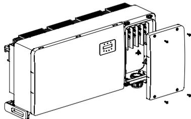
Figura 3.28 Remova a tampa da caixa de junção
