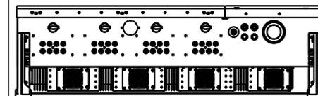
Figura 3.25 Conectar os conectores DC ao inversor
