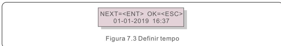
Pressione as teclas UP/DOWN para definir a hora e a data. Pressione a tecla ENTER para passar de um dígito para o próximo (da esquerda para a direita). Pressione a tecla ESC para salvar as configurações e retornar ao menu anterior..
