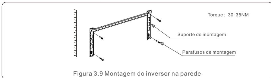
4. Levante o inversor e pendure-o no suporte e, em seguida, deslize-o para baixo para ter certeza de que eles se encaixam perfeitamente.
