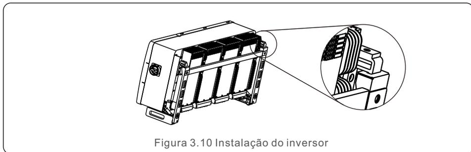
5. Use os parafusos da embalagem para fixar o inversor no suporte de montagem.
